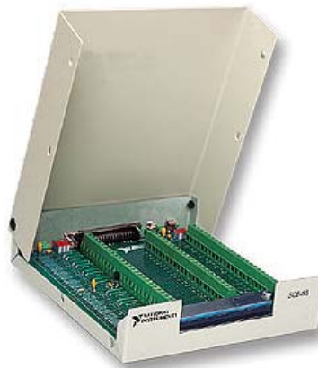
Figura 3.15: Conector externo de 68 pinos da placa de aquisição.
