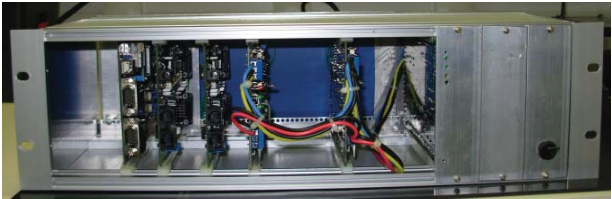
Figura 3.11: Plataforma Elétrica com fonte, drivers de acionamento, e microprocessadores TINI.
