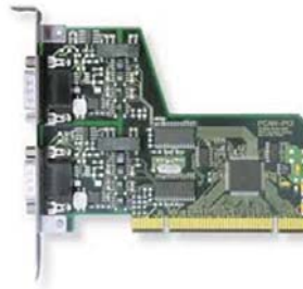
Figura 3.20: Placa Peak Pcan Pci utilizada para monitorar a rede CAN.
