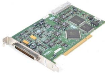
Figura 3.14: Placa de aquisição de dados PCI-6024E da National Instruments
